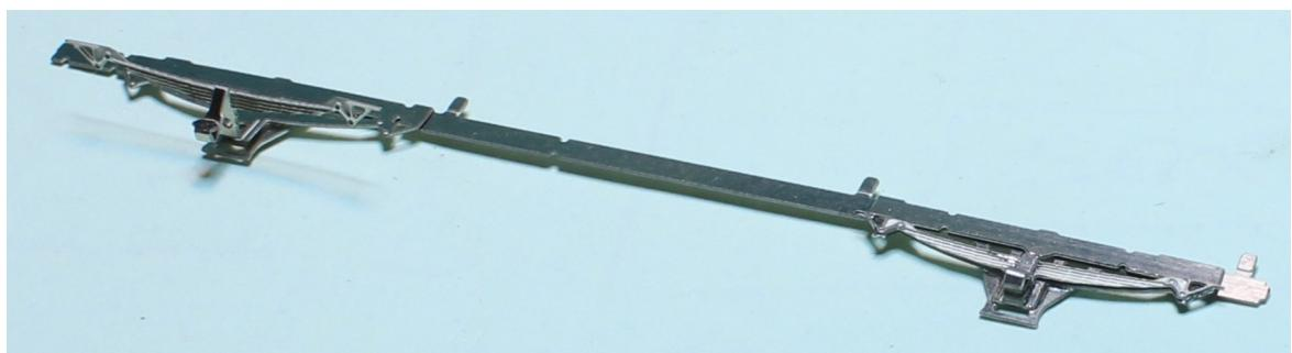
Die Achslagerlöcher kegelig aufbohren. Dafür einen Bohrer passend spitz schleifen oder alternativ bei PeHo (Peter Horn) im Angebot erwerben.
