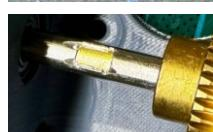
Das Flanschlager (5x11x4) können sie ganz am Ende von außen aufsetzen. Zur Fixierung des Lagers verwenden sie einen Tropfen Sekundenkleber.
