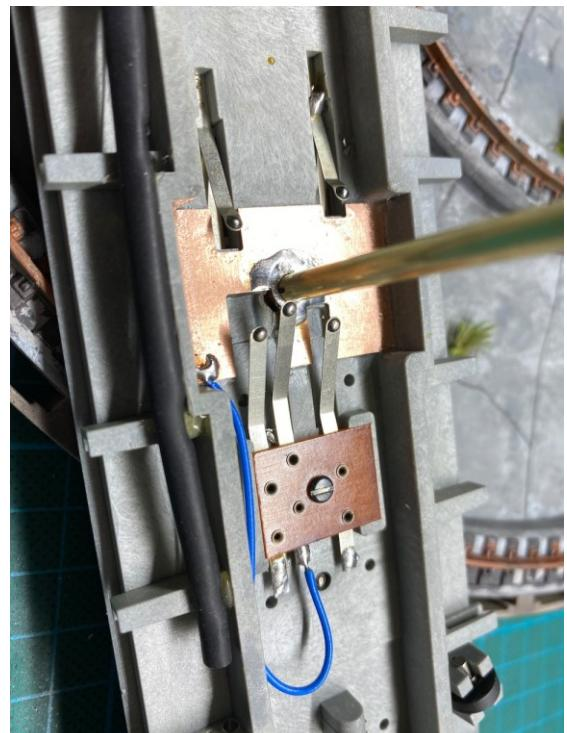
Reinigen sie die Achse und das 6mm Röhrchen, setzen sie die Achse ein und verlöten sie diese mit dem Röhrchen...
