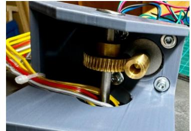
Anschließend schleifen/bohren sie ein 4mm Loch an der Stelle des Abdrucks der Madenschraube in das 5 mm Rohr. Die Madenschraube des Zahnrades muss nun durch das Loch auf die 4mm Achse „greifen“, nur dadurch kann diese sicher fixiert werden.
