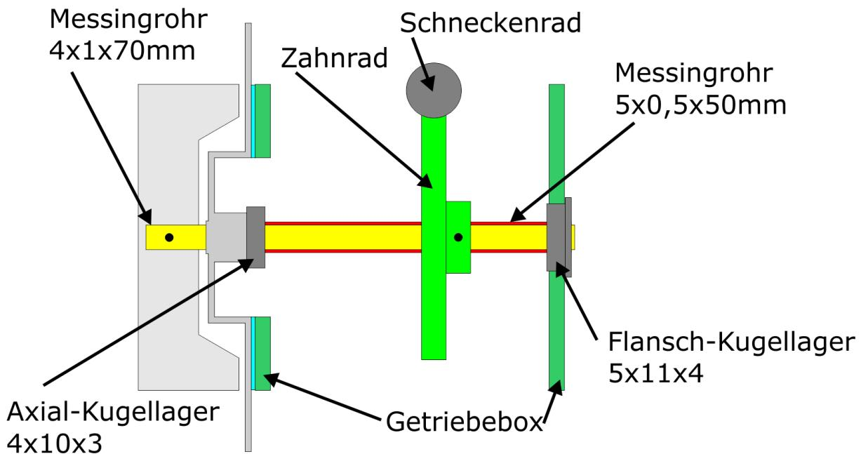
Setzen sie die Bühne in die Grube ein. Dann stecken sie nacheinander das Axiallager und das Zahnrad auf das 4mm Messingrohr. Nun können sie von außen das 5mm Messingrohr durch das Zahnrad über das 4mm Messingrohr schieben.
