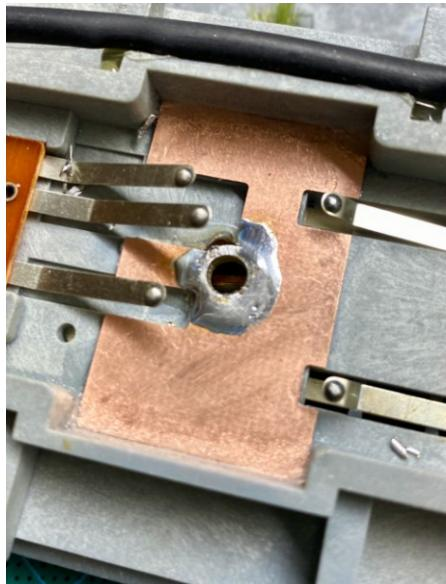
Passen sie nun erneut das 6mm Messingrohr ein. Anschließend wird es oben und unten verlötet, Verwenden sie dazu eine breitere Lötspitze, diese kann die Wärme schneller übertragen. Viel Lötzinn an der Spitze hilft auch die Wärme schnell einzubringen. Reinigen sie die Lötstellen mit einem Glasfaserpinsel, geben sie Flussmittel auf und anschließend mit relativ viel Lötzinn verlöten.
