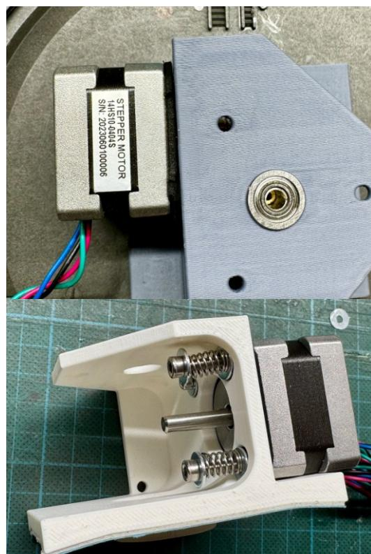
Mittels der M3x20-25 den 2 Unterlegscheiben und der Druckfeder, wird die Schnecke an das Schneckenrad gespannt, dies dient zur Reduzierung des Umlaufspiels (Schlupf).
