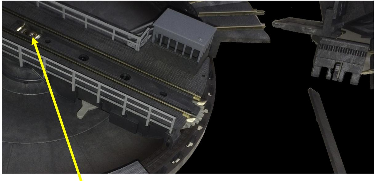
Lösen sie den Sprengring vom Mitteldrehzapfen. Danach können sie die Bühne abheben.
