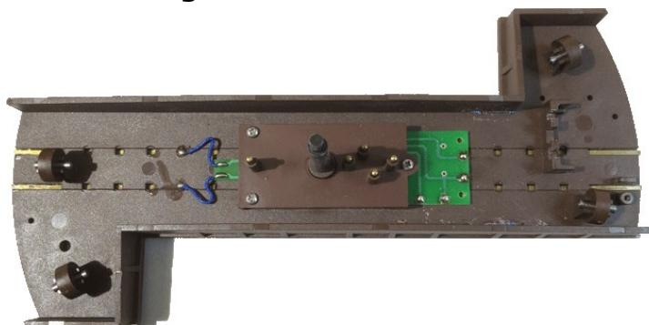
Entfernen sie alle Komponenten der alten Steuerung von der Bühne, den Mikrotaster und auch die Spule. Die drei inneren Ringe werden nicht mehr benötigt und können nun frei verwendet werden.
