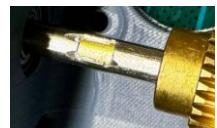
Anschließend schleifen/bohren sie ein 4mm Loch an der Stelle des Abdrucks der Madenschraube in das 5 mm Rohr. Die Madenschraube des Zahnrades muss nun durch das Loch auf die 4mm Achse „greifen“, nur dadurch kann diese sicher fixiert werden.
