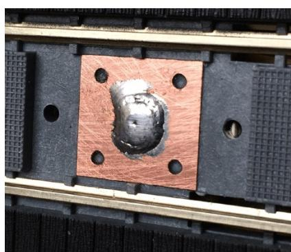
Kleben sie nun die Leiterplatte oben auf die Bühne (Sekundenkleber oder 2K-Harz). Stecken sie die Achse (4mm) Durch und Verlöten diese mit der Platine.
