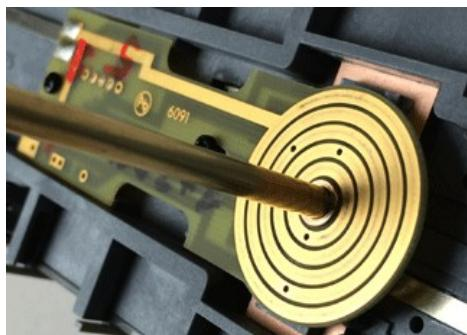
Nun kann die Leiterplatte wieder aufgeschraubt werden. und sie können das Kabel an das nun offene Gleisende Löten.
