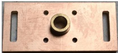
Bereiten sie nun die Untere Befestigung vor um den Drehzapfen einzubauen, hierzu wird das Stück Messingrohr mit der Leiterplatte verlötet, achten sie auf einen senkrechten Sitz.
