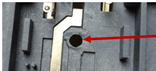
Schneiden sie Plastikstöpsel unten an der Bühne ab.
